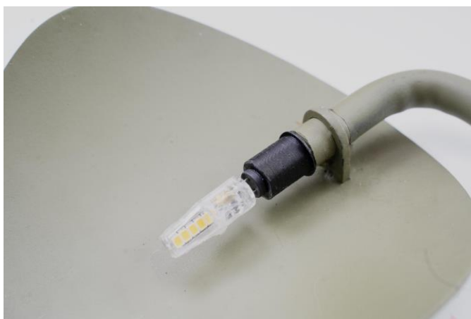
Obrázek 32: umístění zdroje světla a 3D tištěné spojky
