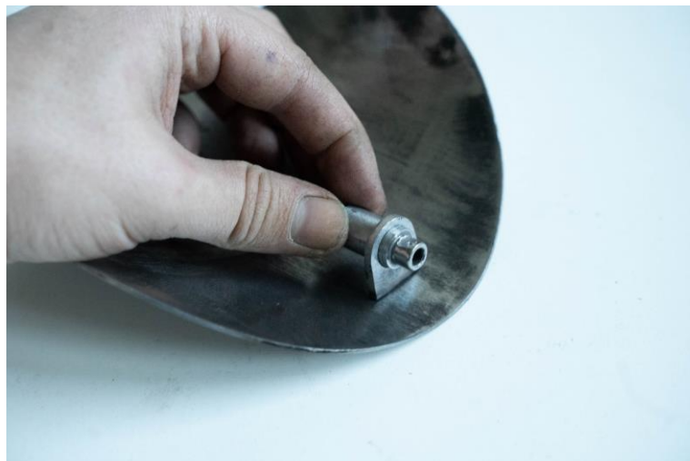
Obrázek 31: ukázka umístění kloubu a jeho spojky před svařením
