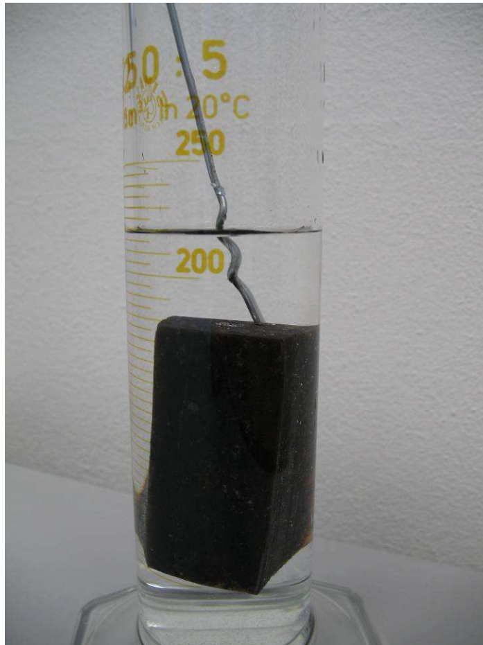
Obr.:28. Měření objemu vzorku v odměrném válci
