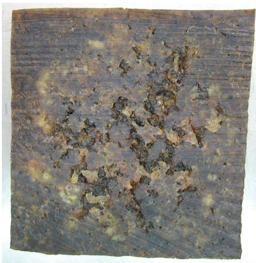
Obr.:24. Dutiny ve vzorku SMR 10/MR 9
