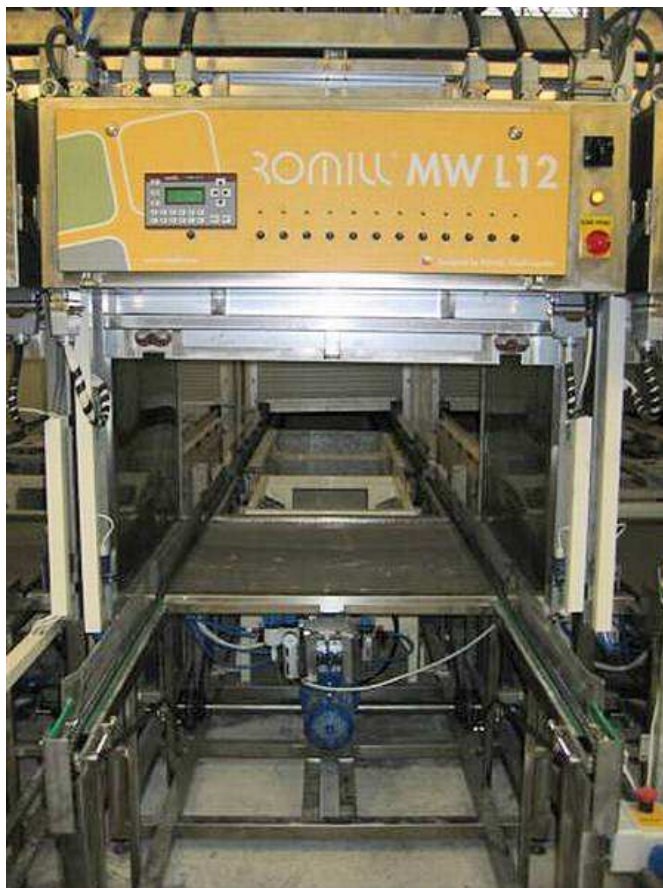
Obr.:5. Pohled do sušící komory sušičky Romill MW L12
