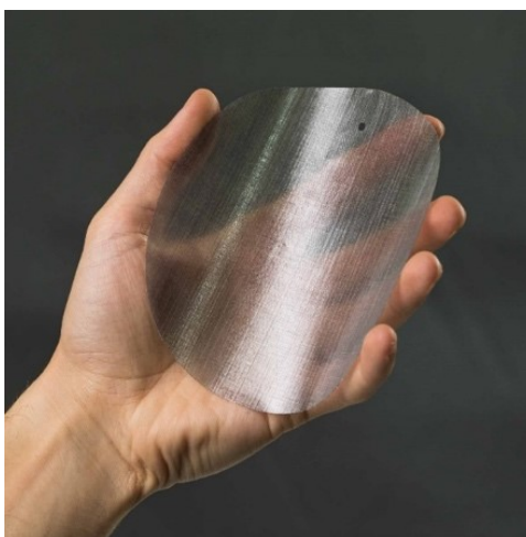
Obrázek 23 Kompozitní textilie Dyneema CT1E.08
