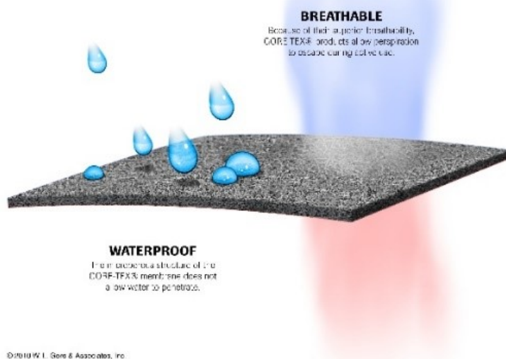
Obrázek 22 Diagram Gore-tex membrány
