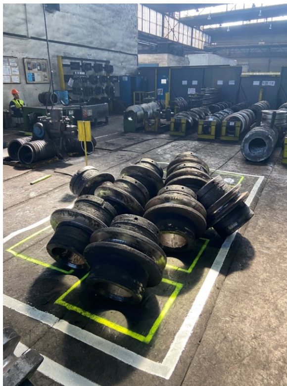
Obrázek 12 Špatné uložení válců (vlastní zpracování)
