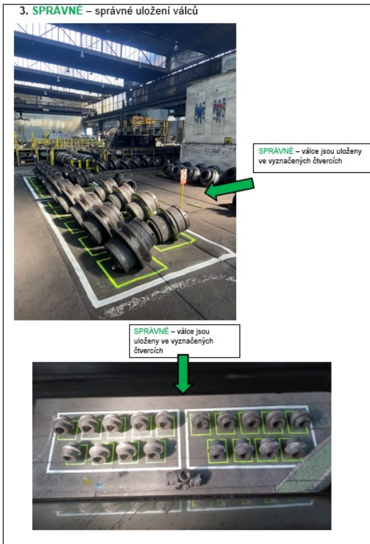
Obrázek 16 Jednobodová lekce – správné uložení válců (vlastní zpracování)
