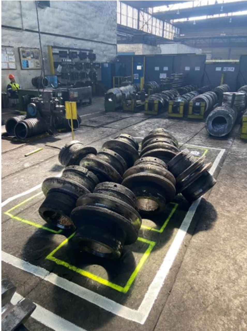
Obrázek 14 Jednobodová lekce – správné uložení válců (vlastní zpracování)
