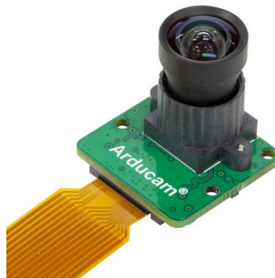
Obrázek 10: Kamerový modul Arducam 12Mpx IMX 477 [3]
