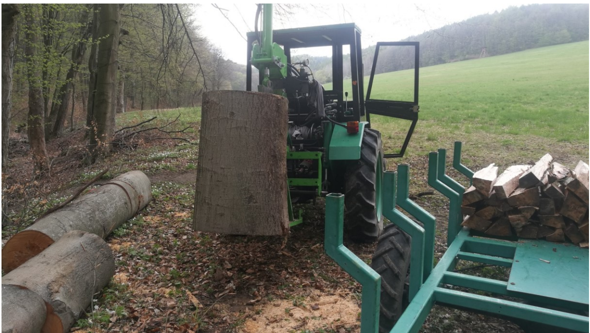
Obrázek 57 Využití zadního závěsu k transportu špalku
