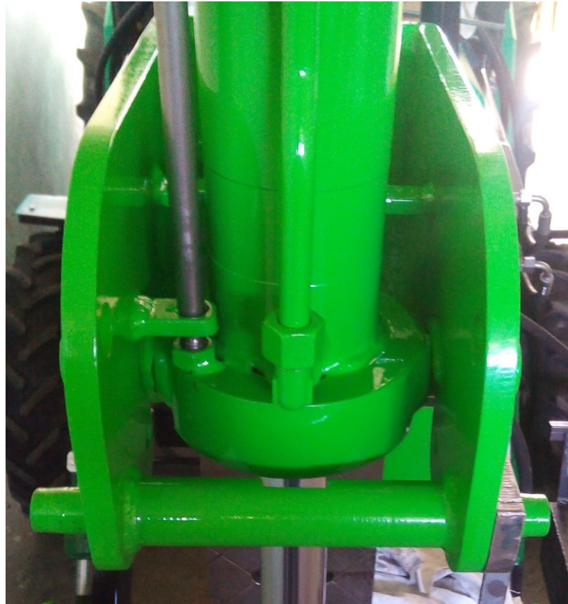
Obrázek 54 Detail vedení hydromotoru a jeho držáku
