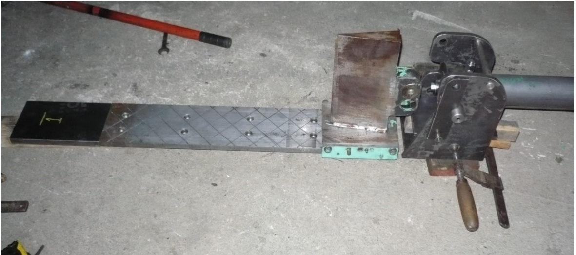
Obrázek 50 Horní část, klín a vodící deska před svařováním
