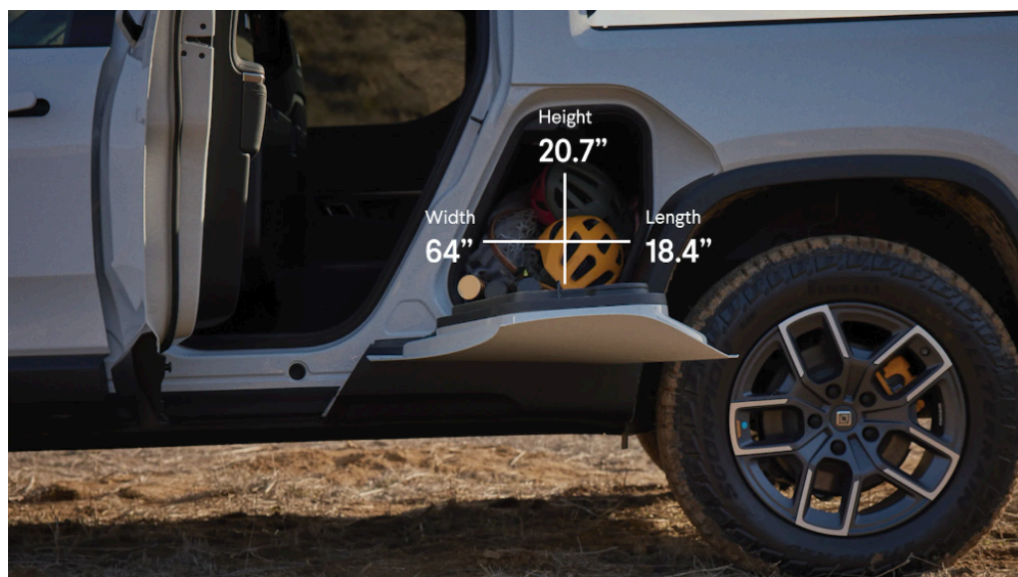
Obrázek 33 - Převodový tunel (zdroj: Rivian)
