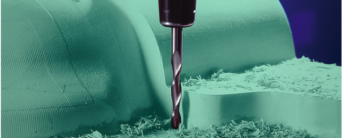
Obrázek 25 Obrábění epoxidové desky [54]
