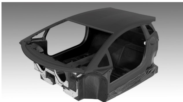
Obrázek 17 Skořepina Lamborghini Aventador [40]
