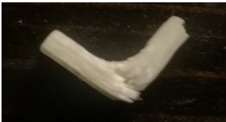
Obrázek 56 Skelné tělísko po metodě krátkého nosníku
