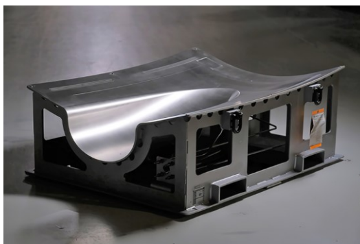
Obrázek 23 Forma z invaru [50]
