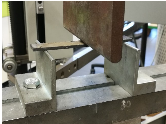
Obrázek 42 Experimentální zkouška ohybem
