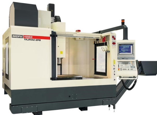
Obr. 16 Vertikální obráběcí centrum Tajmac ZPS MCFV 1060 [17]
