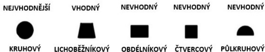
Obrázek 24 Typy průřezů rozvodných kanálů [20]
