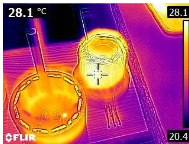
Obrázek 45 Snímek statoru dle Laimera z termokamery Flir
