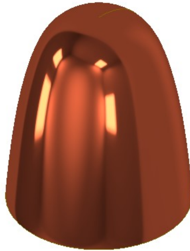
Obr. 29 Model pláště střely
