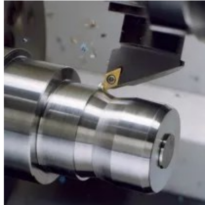
Obr. 5 – Soustružení podélných/válcových ploch [12]
