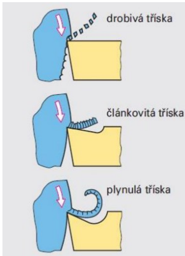
Obr. 11 – Tři základní vzhledy třísek [13]
