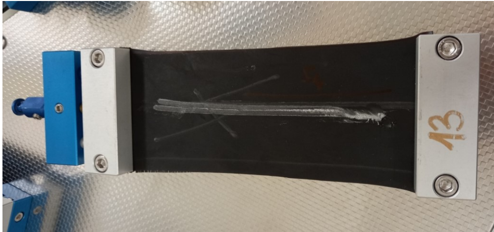
Obrázek 15: Vzorek v držáku napjatý na 20% prodloužení
