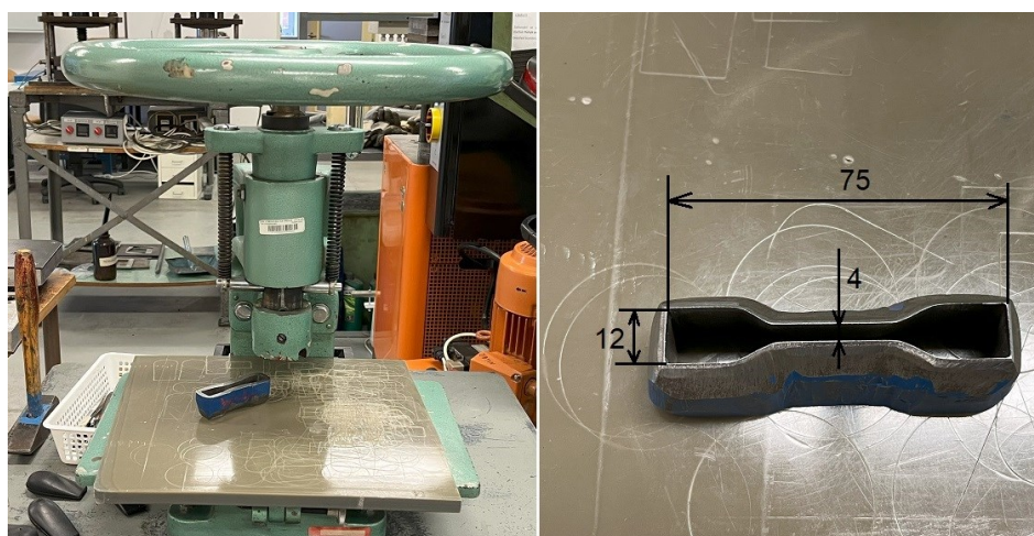
Obrázek 40: Ruční vysekávačka (vlevo), vysekávací nůž (vpravo) [112]
