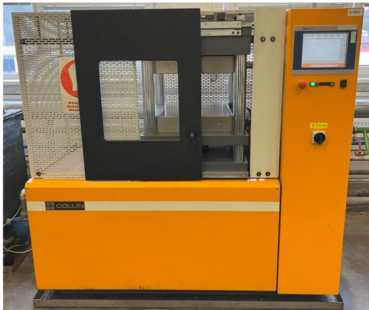
Obrázek 39: Laboratorní etážový lis Collin P 400 [112]
