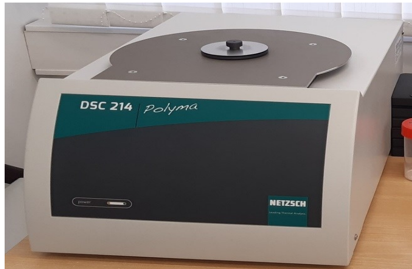
Obrázek 51: DSC zařízení Netzsch DSC 214 Polyma [112]
