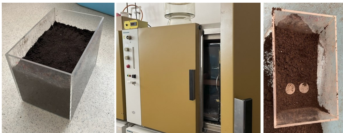
Obrázek 59: Zahrabání do zeminy. Vlevo nádoba se zeminou a vzorky, uprostřed klima komora, vpravo vyjmutí vzorků [112]
