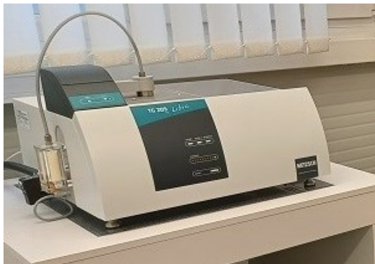
Obrázek 46: TG zařízení Netzsch TG 209 F1 Libra [112]
