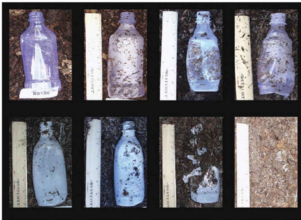
Obrázek 9: Biodegradace PLA lahve v podmínkách kompostování (80 % biologický rozklad po 58 dnech při teplotě 58 °C) [31]
