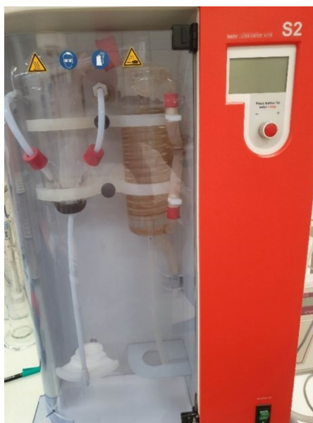
Obrázek 3 Destilační jednotka S2 od společnosti Behr
