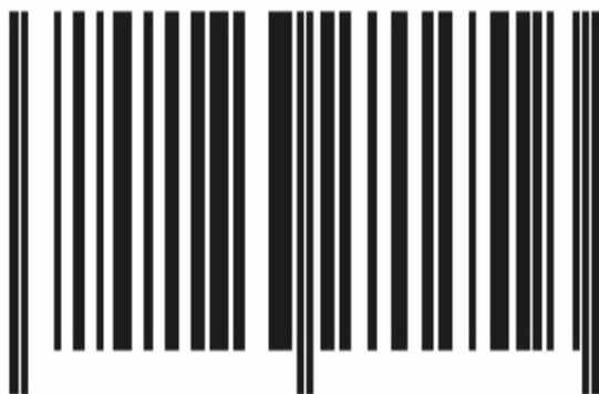
Obr. 5. Princip jednorozměrného (1 D) optického kódu: sled čar různé šířky
