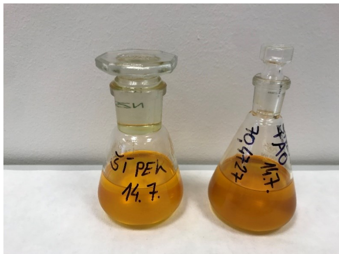
Obrázek 27 Rozdíl v barvě u vzorku šípkového oleje skladovaného ve skle čirém (vlevo) a ve skle čirém s přidaným antioxidantem (vpravo)
