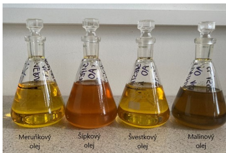
Obrázek 16 Vzorky rostlinných olejů skladovaných v zábrusových Erlenmeyerových baňkách z čírého skla s přidaným antioxidantem
