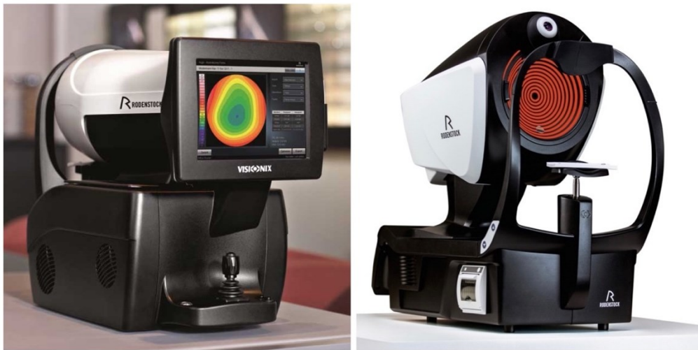
Obrázek 17 Rodenstock DNEye® Scanner, vlevo přístroj z pohledu vyšetřujícího, vpravo z pohledu zákazníka.
