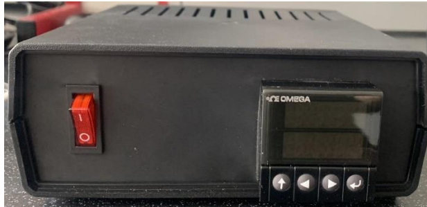
Obr. 26 Predný panel CN16DPT-305-EIP-DC
