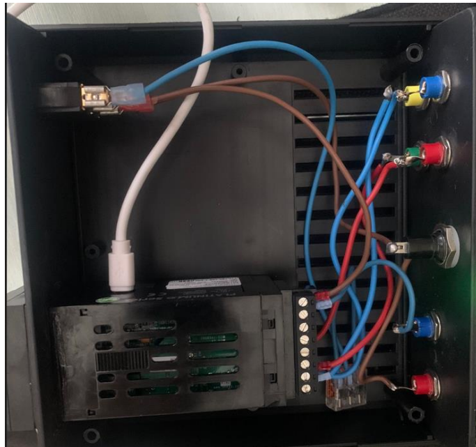
Obr. 28 Vnútro krabičky s CN16DPT-305-EIP-DC
