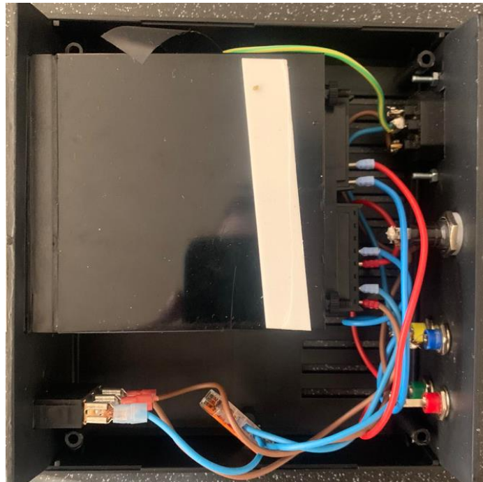
Obr. 25 Vnútro krabičky s CNI853
