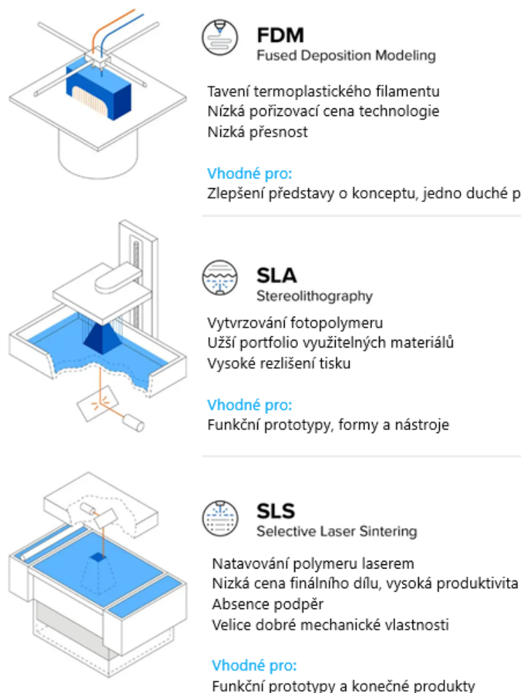
Obr. 19 Porovnání nejznámějších technologií 3D tisku [30]
