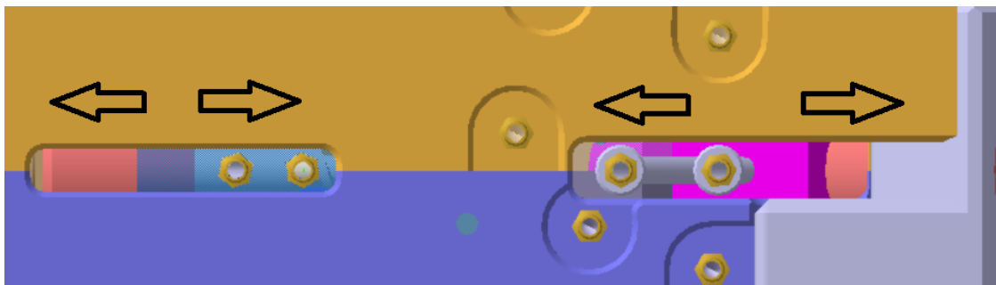
Obr. 49 Temperace - pohled z boku na formu (šipkami znázorněn směr posouvání)
