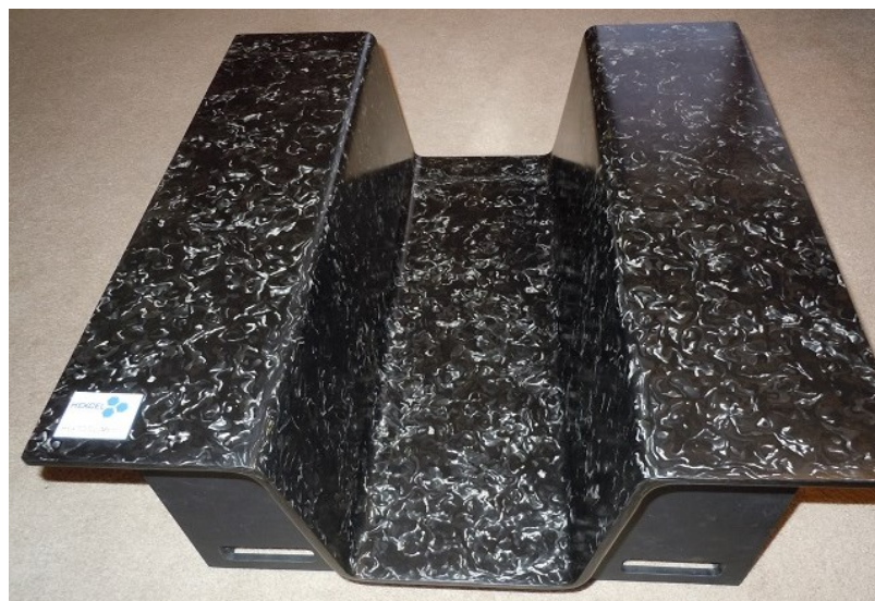
Obrázek 16 Kompozitní nástroj vyrobený pomocí tooling prepregu HexTOOL ® [30]
