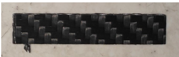
Obrázek 62 Nařezaný zkušební vzorek pro zkoušku rázové houževnatosti
