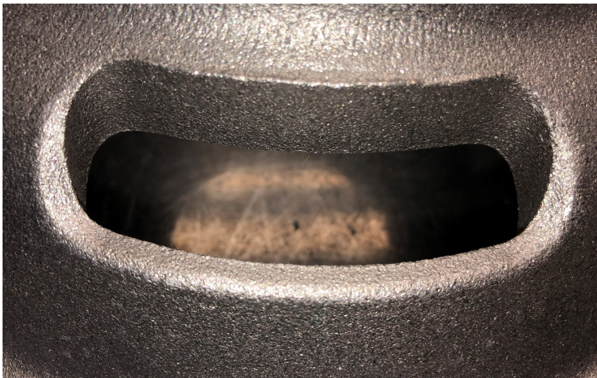
Obrázek 87 Pohled na tvarovou díru u 1500. výkovku
