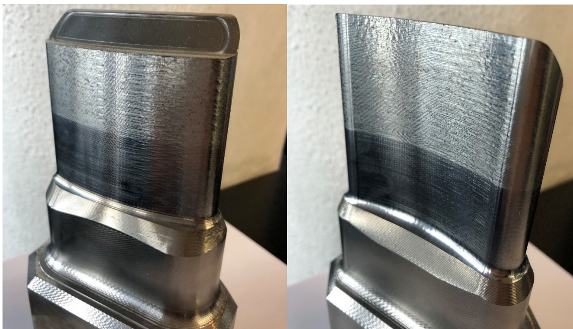
Obrázek 82 Nevhodný povrch razníku po obráběcí operaci
