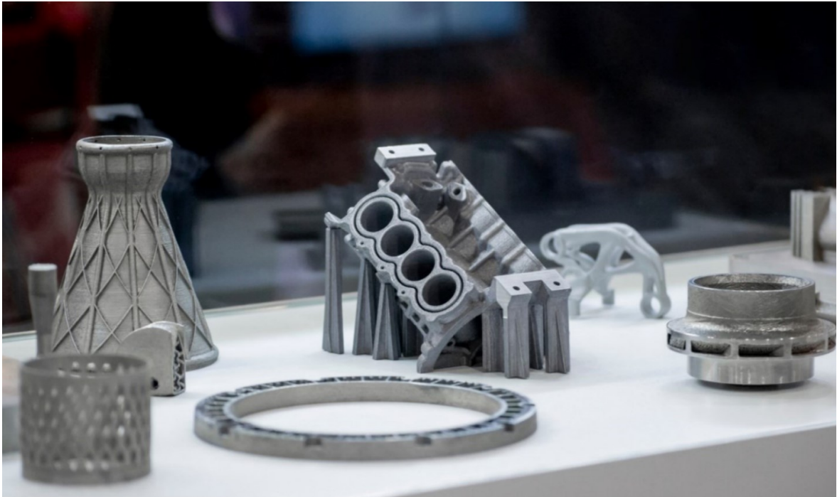
Obrázek 25 Součásti se složitou geometrií vytvořené metodou DMLS [37]
