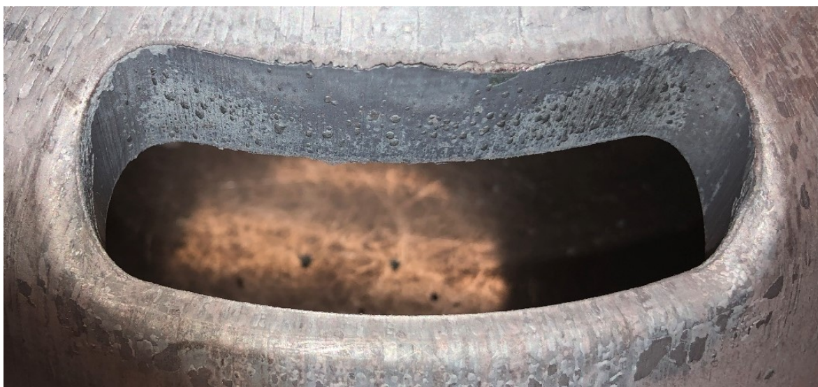
Obrázek 87 Pohled na tvarovou díru u 1500. výkovku
