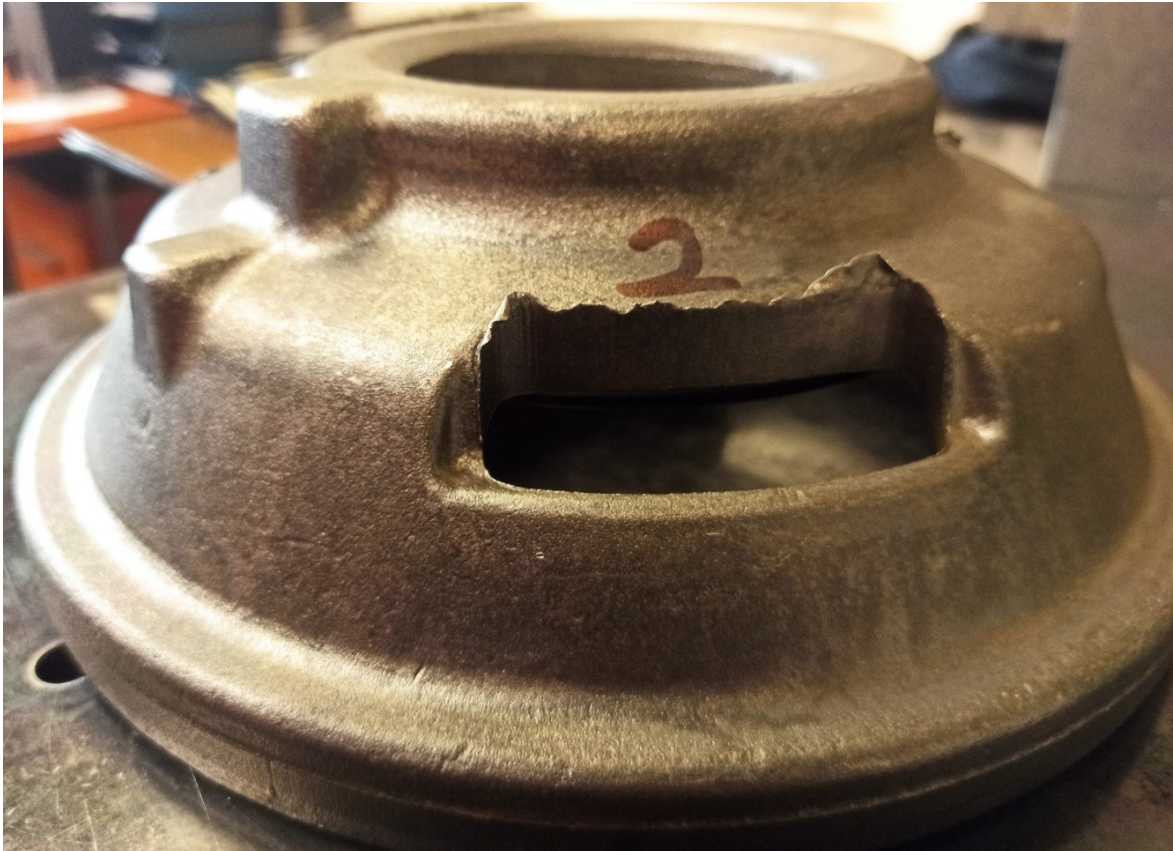
Obrázek 64 Nežádoucí otřep na 1500. výkovku důsledkem opotřebení tvarového razníku
