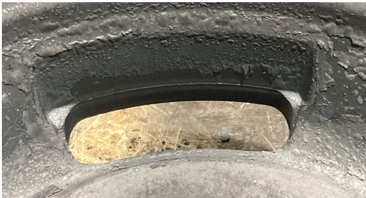
Obrázek 73 Výkovek po odkování cca 500 ks
