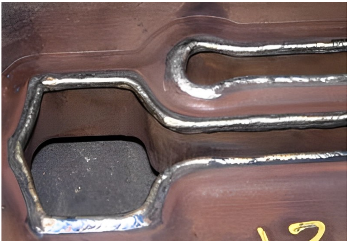
Obrázek 31 Navařená funkční část ostříhovacího nástroje [49]
