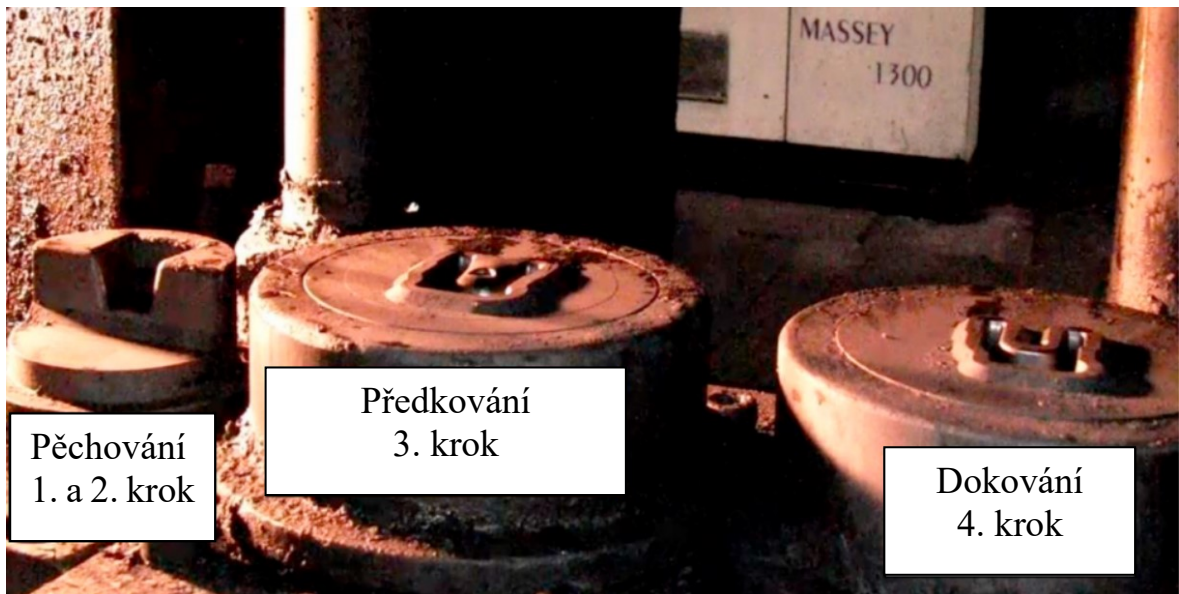
Obrázek 3 Pohled na spodní (nepohyblivé) části zápustek upevněné na stroji Massey 1300T [7]
