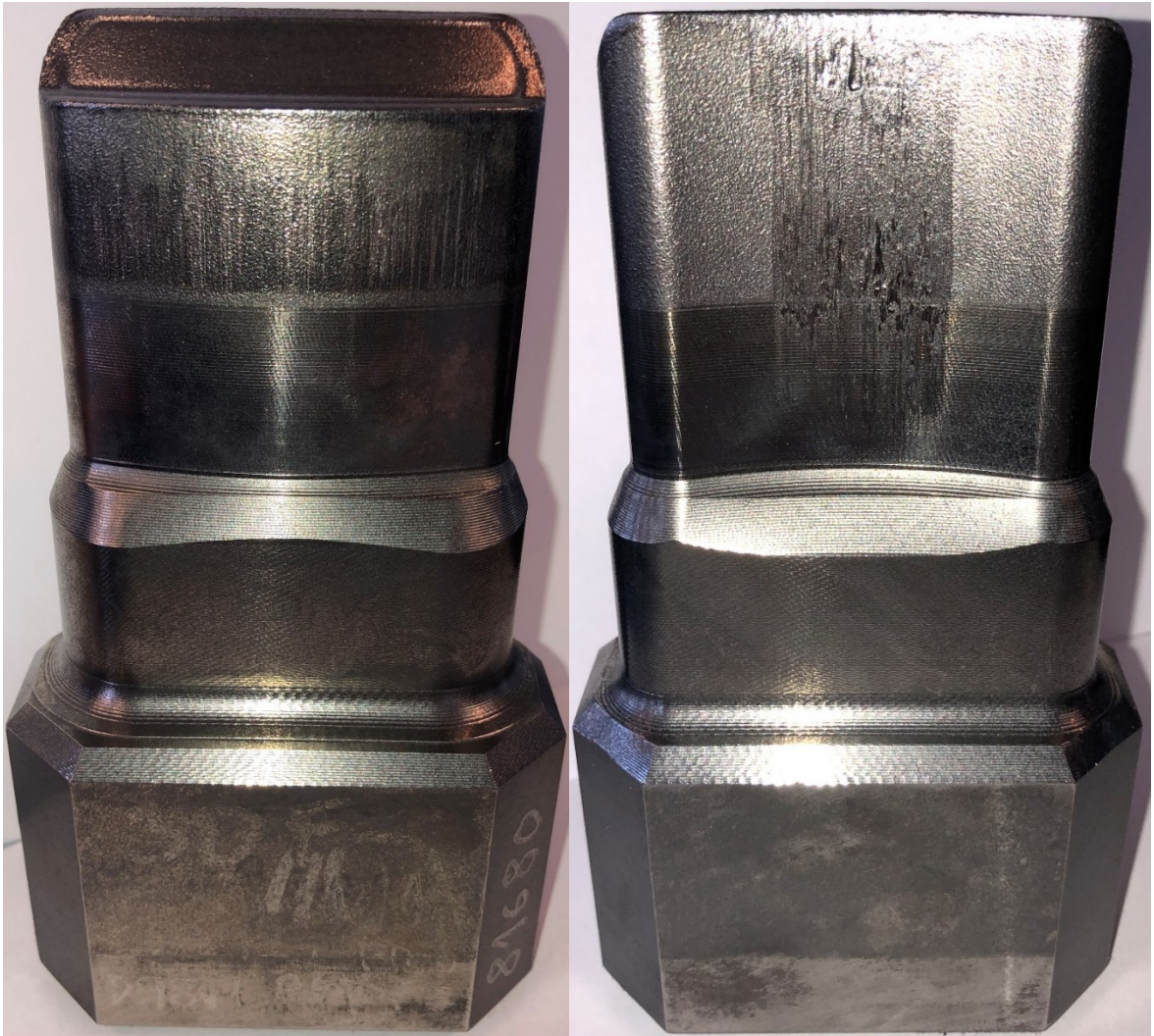
Obrázek 84 Tvarové razníky po kompletním kování
