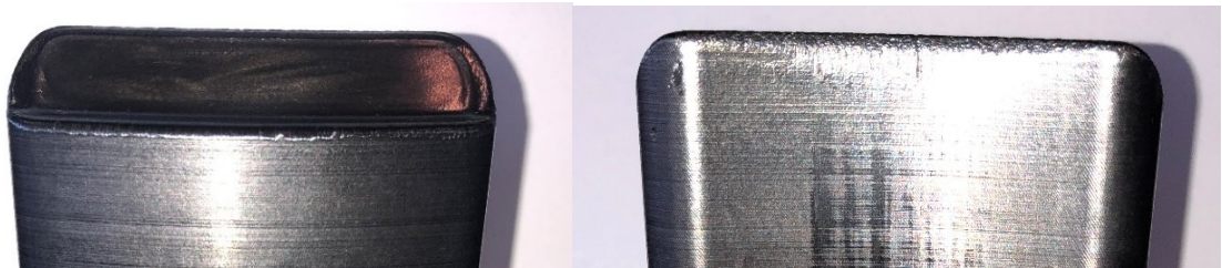
Obrázek 76 Detailní pohled na opotřebené tvarové razníky z FTCo po konci kování 2500 kusů
