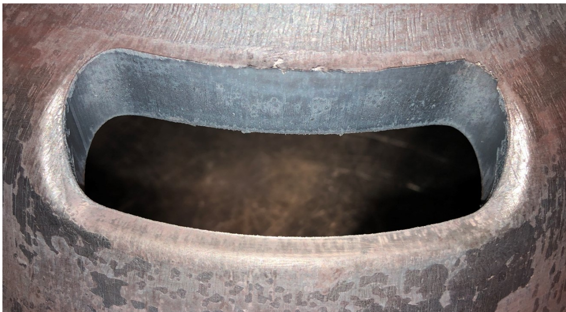
Obrázek 86 Pohled na tvarovou díru u 1000. výkovku
