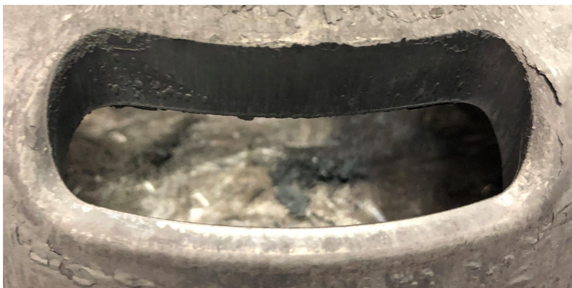
Obrázek 73 Výkovek po odkování cca 500 ks
