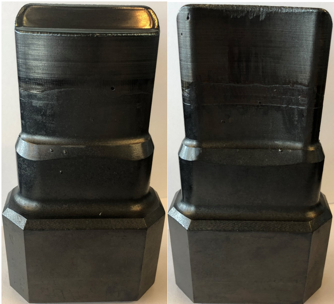
Obrázek 77 Tvarové razníky z oceli ČSN 19 552 renovovány Capilla elektrodami
