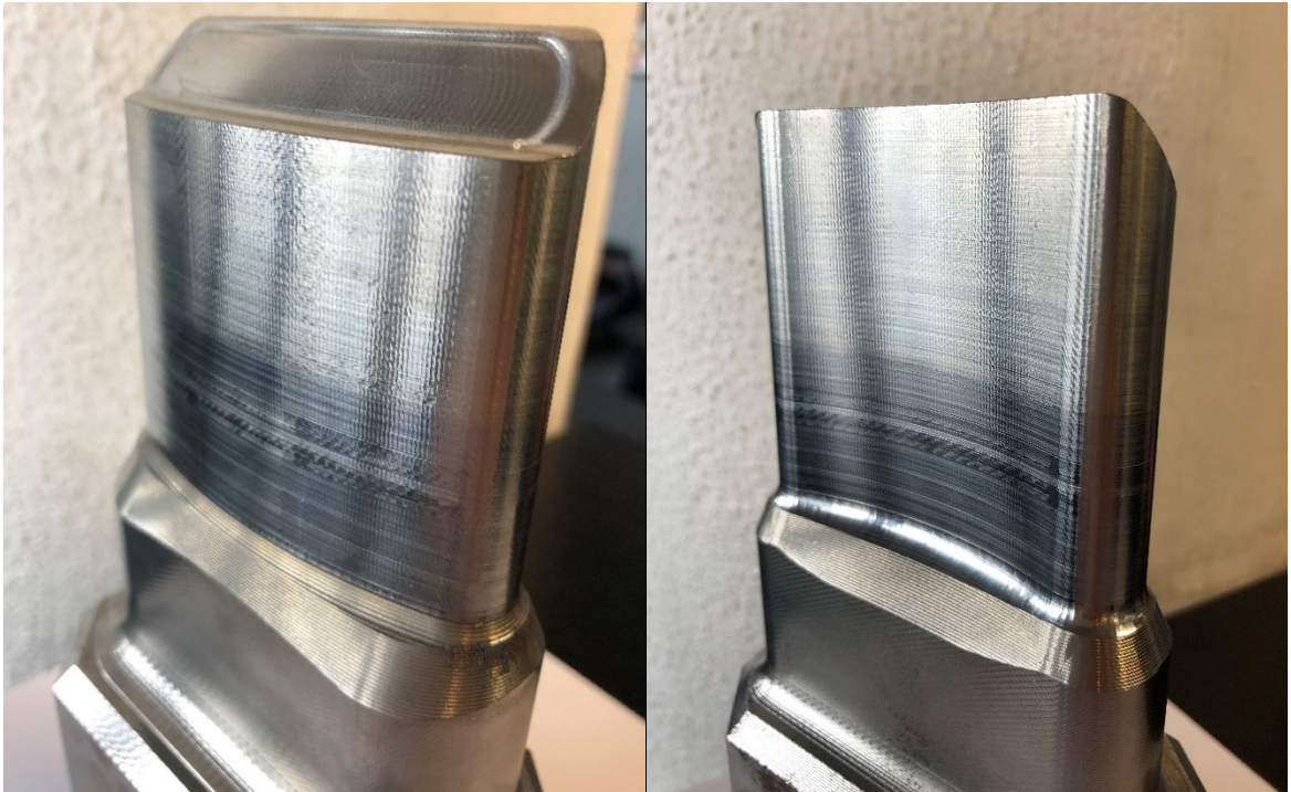
Obrázek 83 Vhodný povrch razníku po obráběcí operaci
