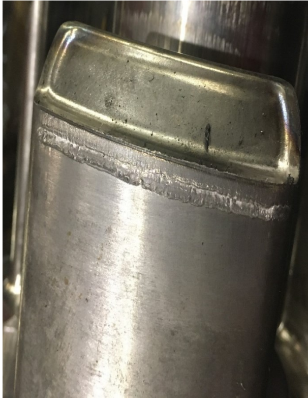
Obrázek 63 Opotřebené tvarové razníky (první verze) z oceli ČSN 19 552 po kovací operaci
