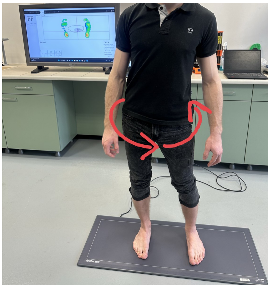
Obr. 26.: Postup kinematického (balančního) měření plantárních tlaků.
