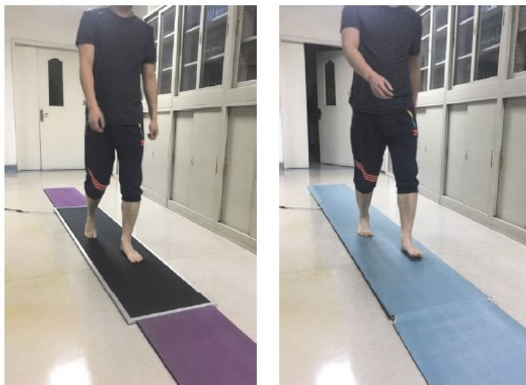
Obr. 12.: Testování pomocí platformy Footscan: levá strana bez využití svrchní vrstvy, pravá strana s využitím horní vrstvy. [19]
