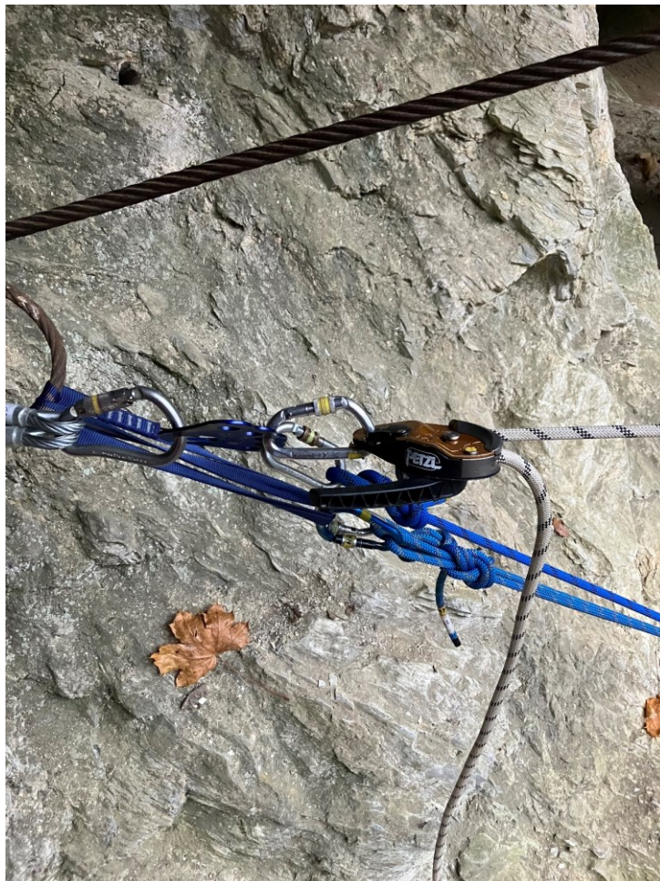
Obrázek 21: kotvení pomocí RIGu (vlastní zdroj, 2022)
