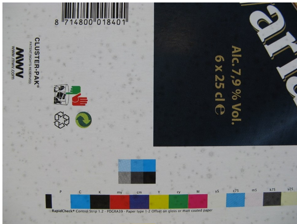
Obrázek 6 Olejové skvrny na výrobku (zdrojová data: interní zdroje firmy, vlastní zpracování)
