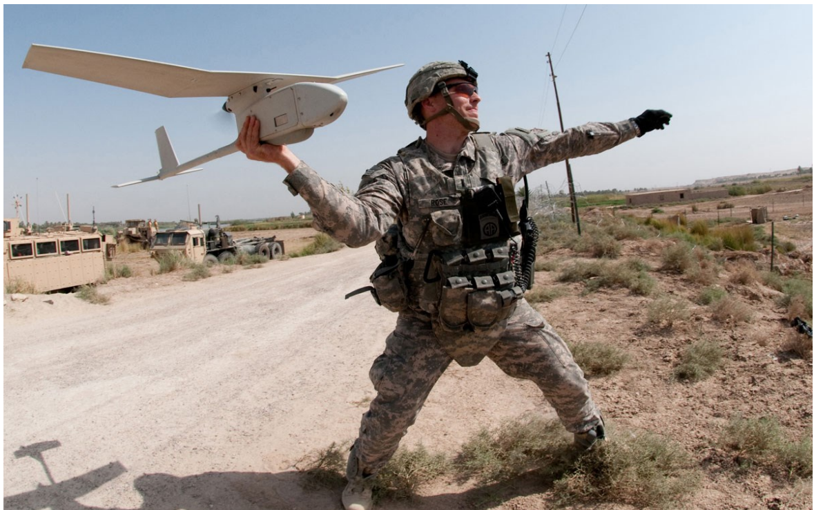
Obrázek 9 Raven RQ - 11 B při zahájení provozu vypuštěním z ruky
