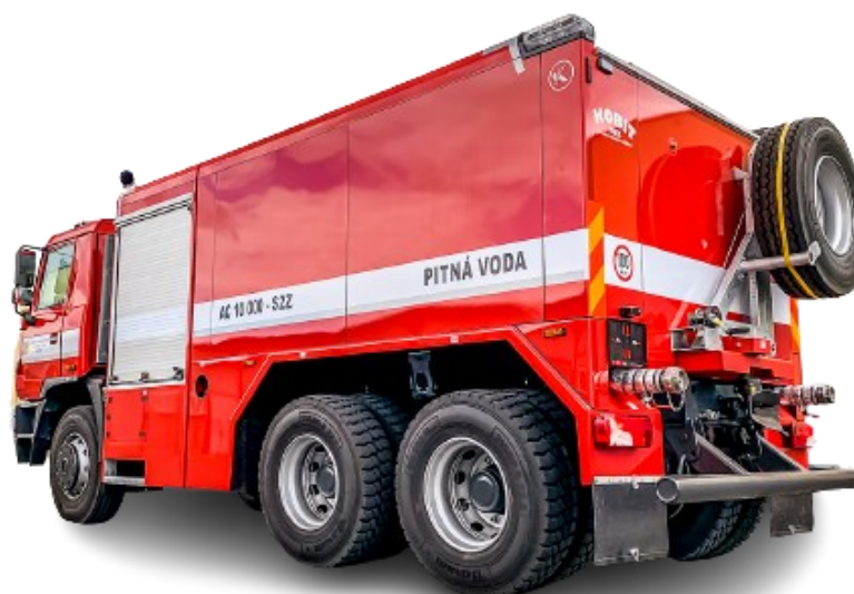
Obrázek 22: Cisterna na přepravu vody Záchranného útvaru HZS ČR, (Cisternu na přepravu vody pro Záchraný útvar HZS ČR postavila firma Kobit-THZ na podvozku Tatra Terrno, 2019)
