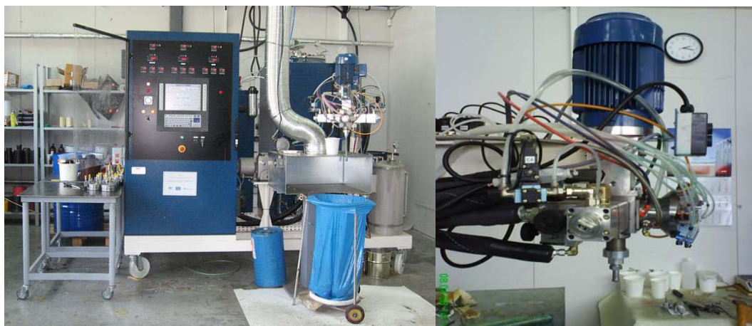
Obr. 20 a) Tříkomponentní nízkotlaký licí stroj UM 3C/CV, b) Licí hlava stroje
