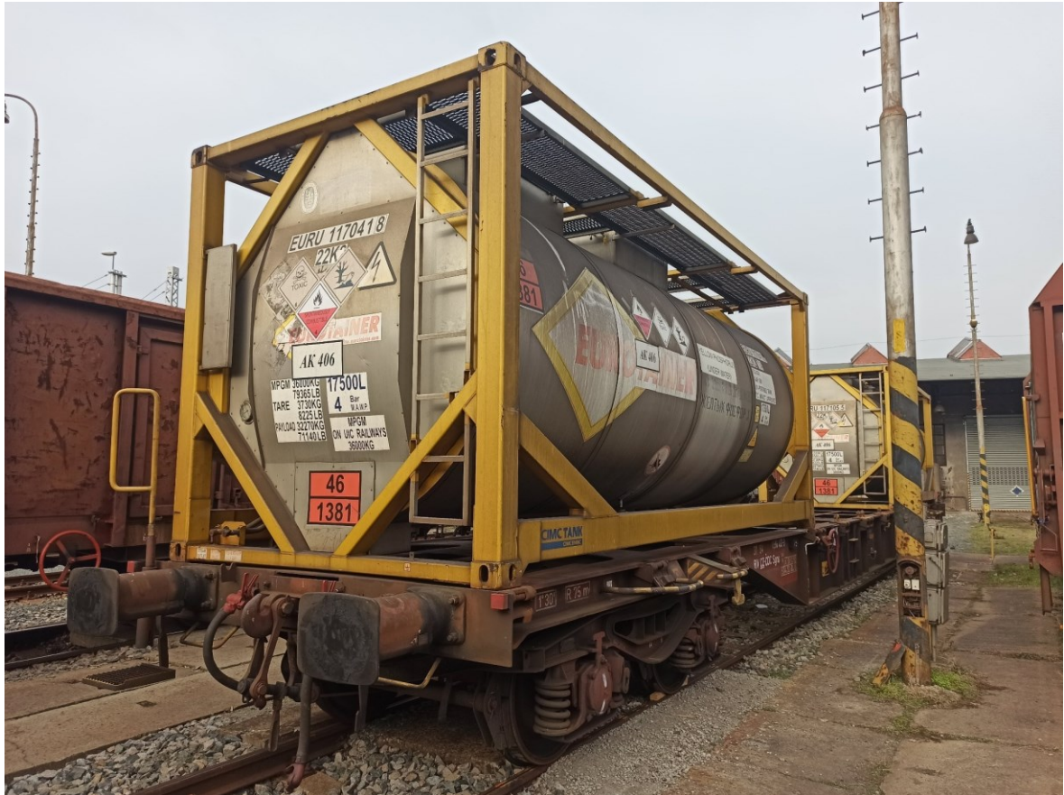
Obrázek 3 Cisternový kontejner na plošinovém voze v železniční stanici Břeclav (Zdroj vlastní)
