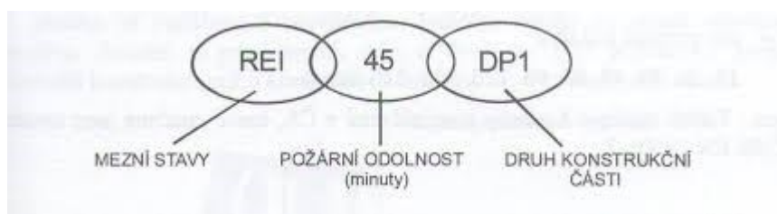
Obrázek 3 – Požární odolnost stavební konstrukce – příklad
