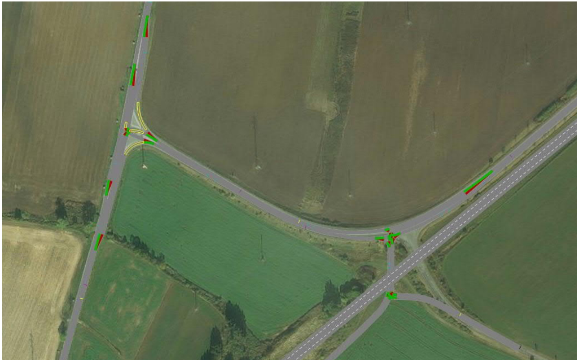
Obrázek 46 Varianta s připojovacími pruhy s dálnicí v programu PTV Vissim (Vlastní tvorba, 2022)
