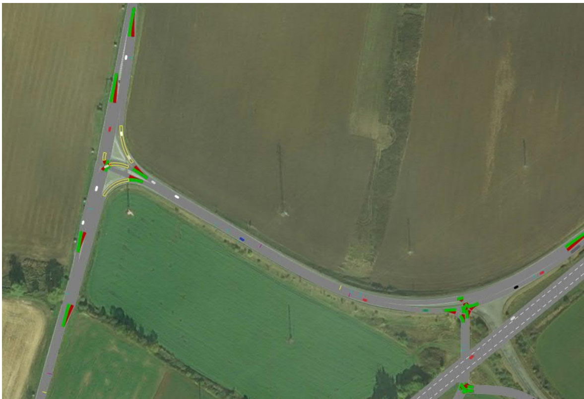
Obrázek 47 Simulace s připojovacími pruhy s dálnicí (Vlastní tvorba, 2022)
