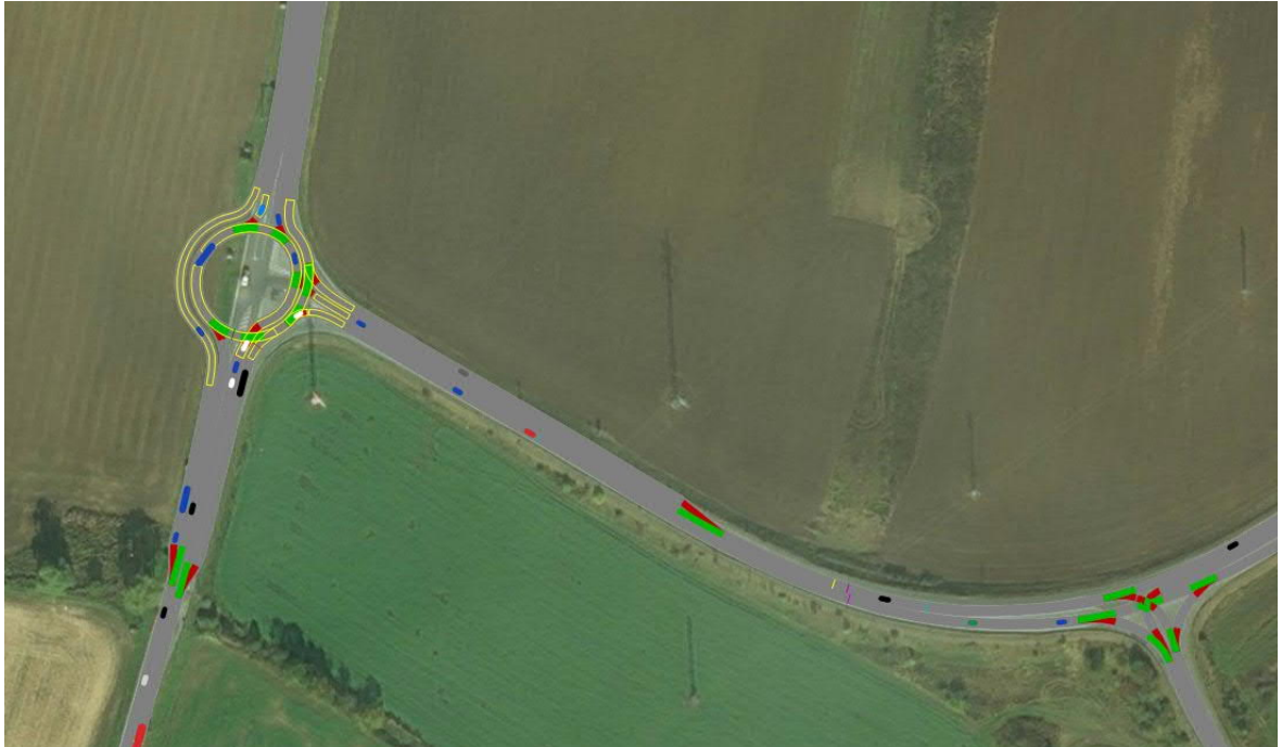
Obrázek 36 Simulace varianty s turbookružní křižovatkou (Vlastní tvorba, 2022)
