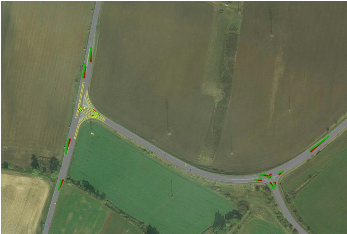
Obrázek 32 Varianta s připojovacími pruhy v programu PTV Vissim (Vlastní tvorba, 2022)
