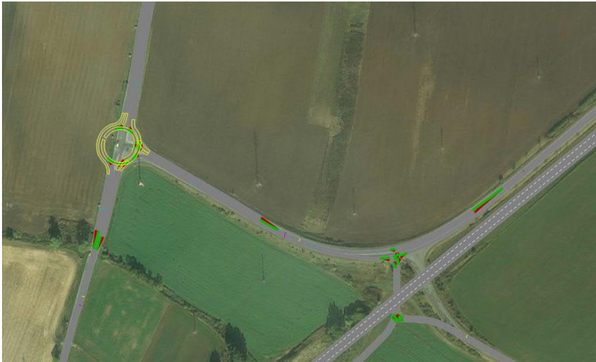
Obrázek 49 Varianta s turbookružní křižovatkou s dálnicí v programu PTV Vissim (Vlastní tvorba, 2022)
