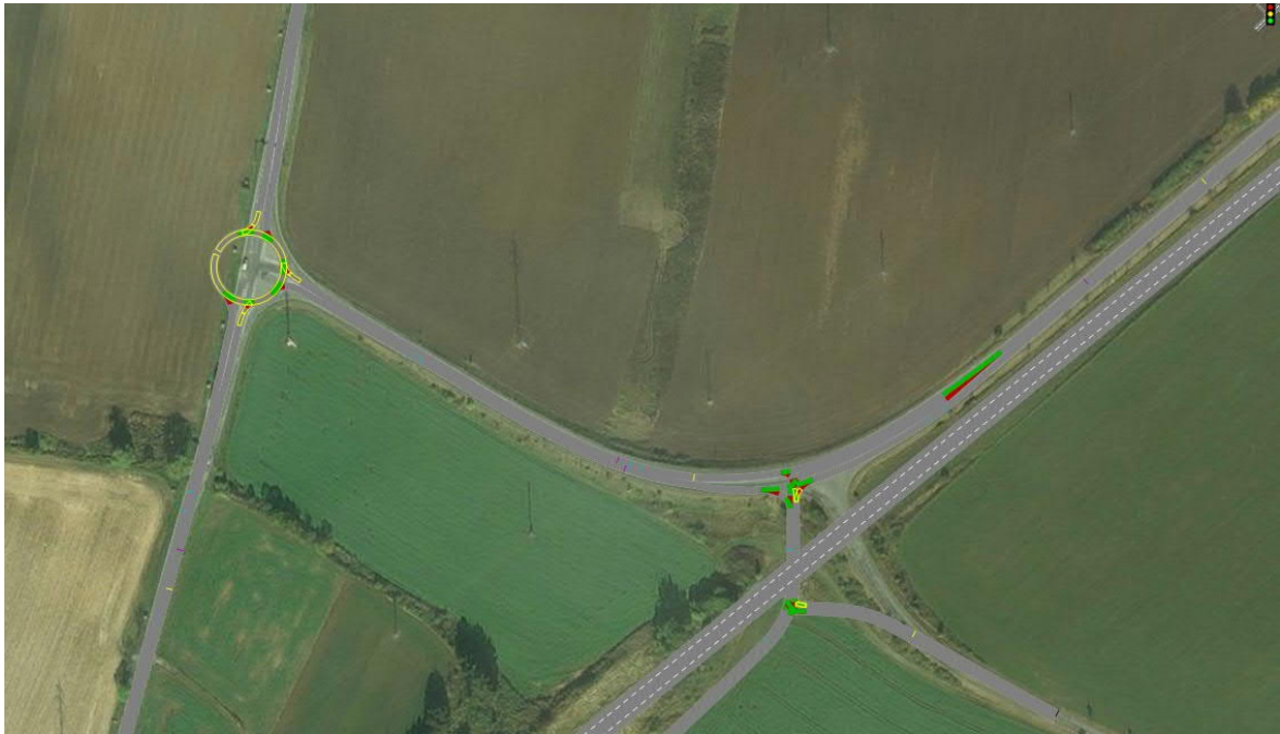
Obrázek 43 Varianta s kruhovým objezdem s dálnicí v programu PTV Vissim (Vlastní tvorba, 2022)
