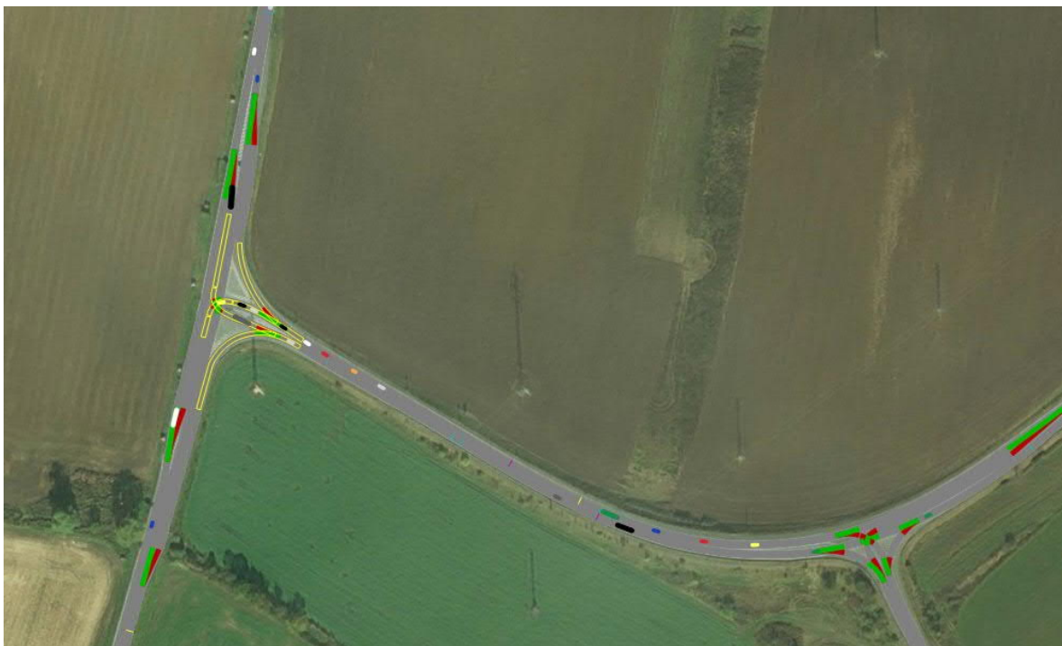
Obrázek 33 Simulace varianty s připojovacími pruhy (Vlastní tvorba, 2022)
