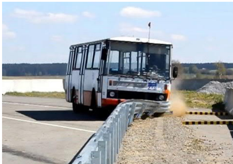
Obrázek 5 Deformace svodidla po nárazu (Vaniš a Mikula, 2016)
