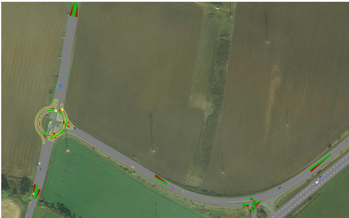
Obrázek 50 Simulace s turbookružní křižovatkou s dálnicí (Vlastní tvorba, 2022)
