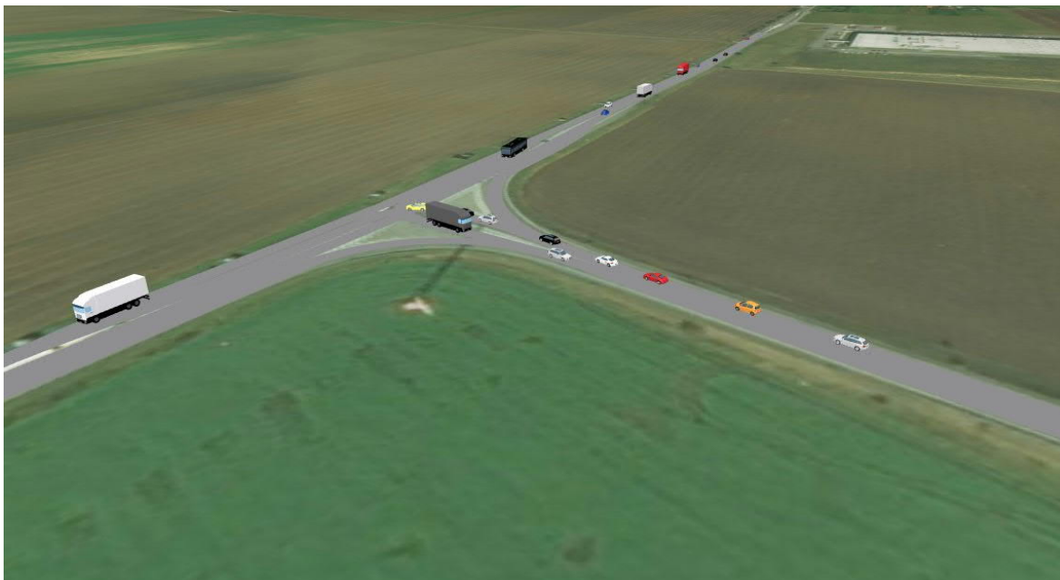
Obrázek 34 3D pohled simulace s přípojovacími pruhy (Vlastní tvorba, 2022)
