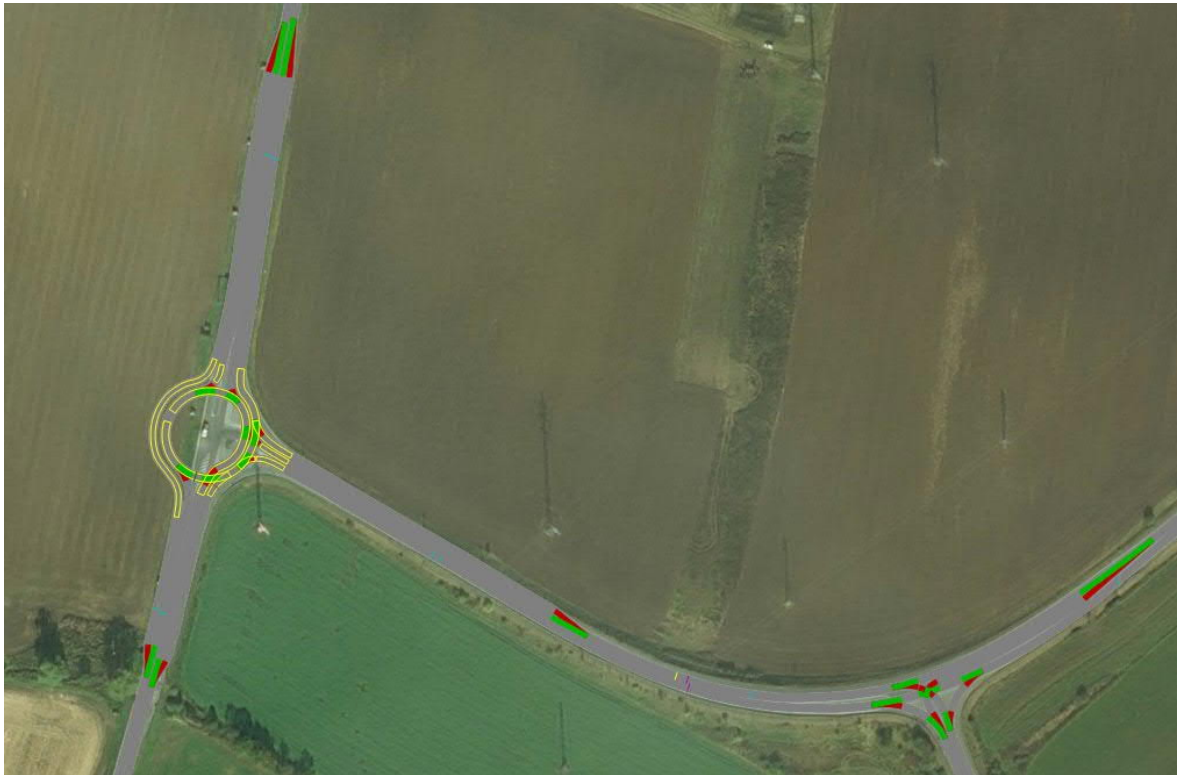
Obrázek 35 Varianta s turbookružní křižovatkou v programu PTV Vissim (Vlastní tvorba, 2022)
