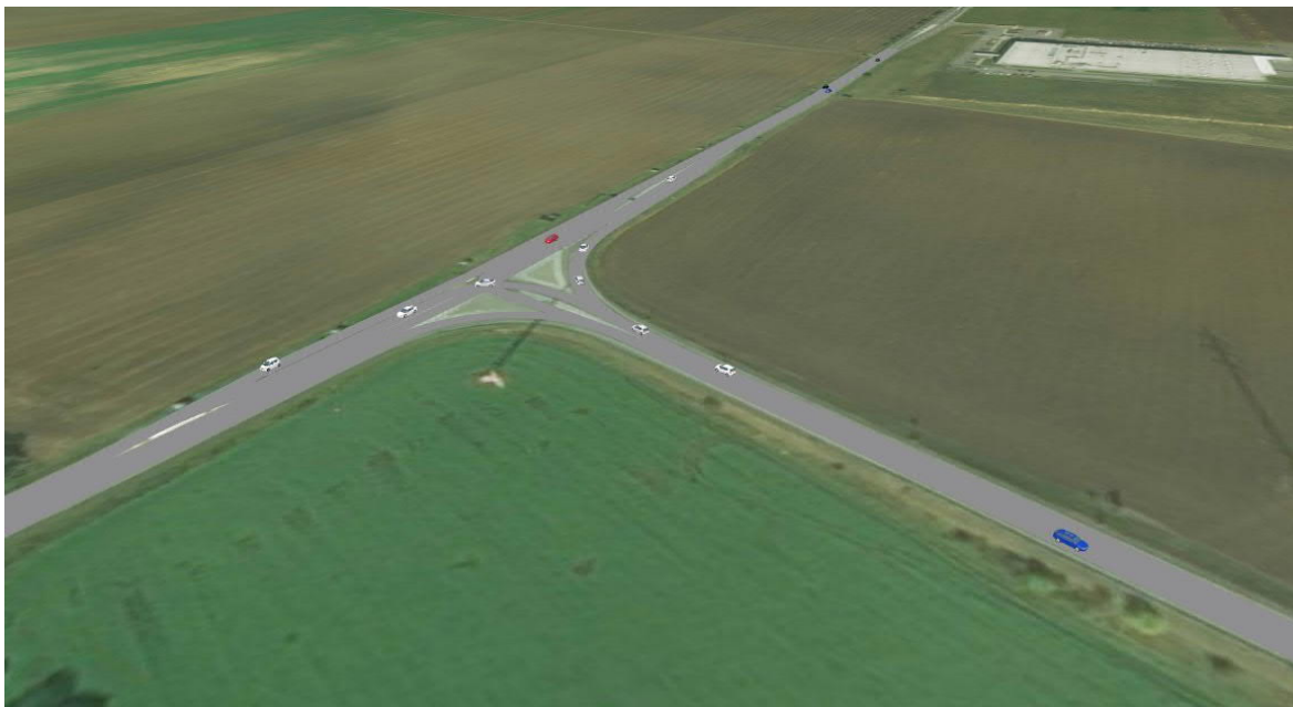
Obrázek 48 3D pohled simulace s přípojovacími pruhy s dálnicí (Vlastní tvorba, 2022)
