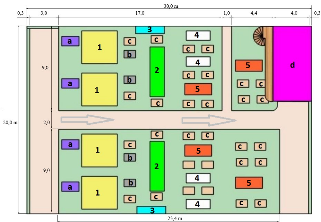
Obrázek 10 Současná výrobní hala – 2D pohled (Vlastní vypracování)
