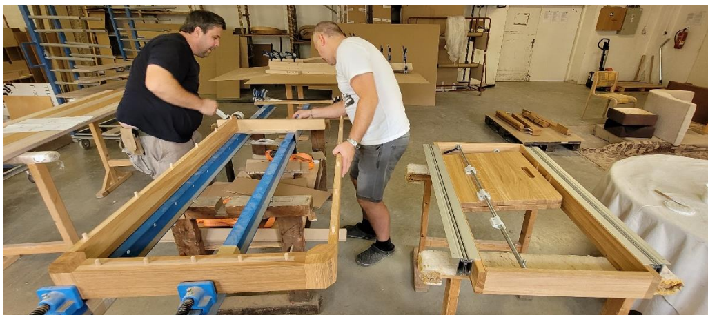
Obr.75 Rám s výsuvem (napravo) a rám stolu – lub (nalevo)
