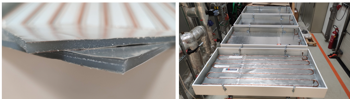
Obr. 4.3 Příprava: detail PCM a připravené boxy.
