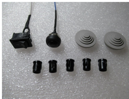
Obr. 29. Kabelové průchodky, objímky na LED diody, tlačítko a spínač.
