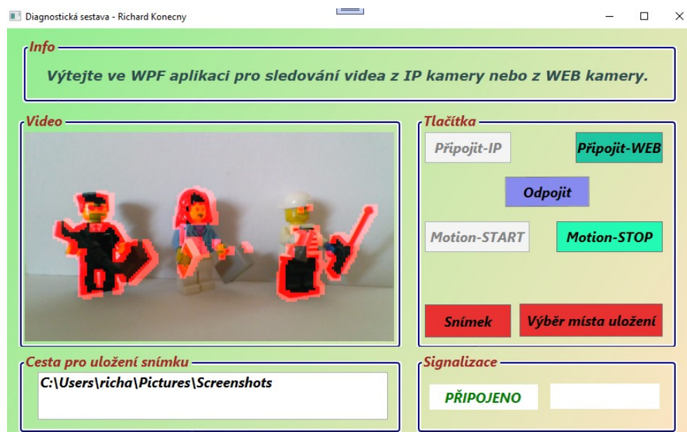
Obr. 99. WPF aplikace – aktivování funkce Motion Detection.
