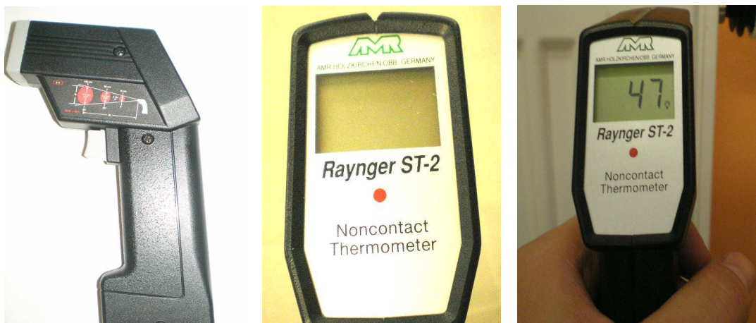
Obr. 13. Měřicí přístroj Pyrometr AMIR 7811
