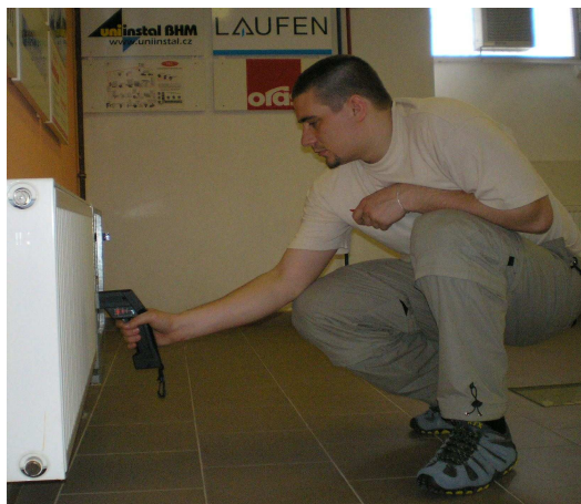
Obr. 28. Měření teploty povrchu OT
