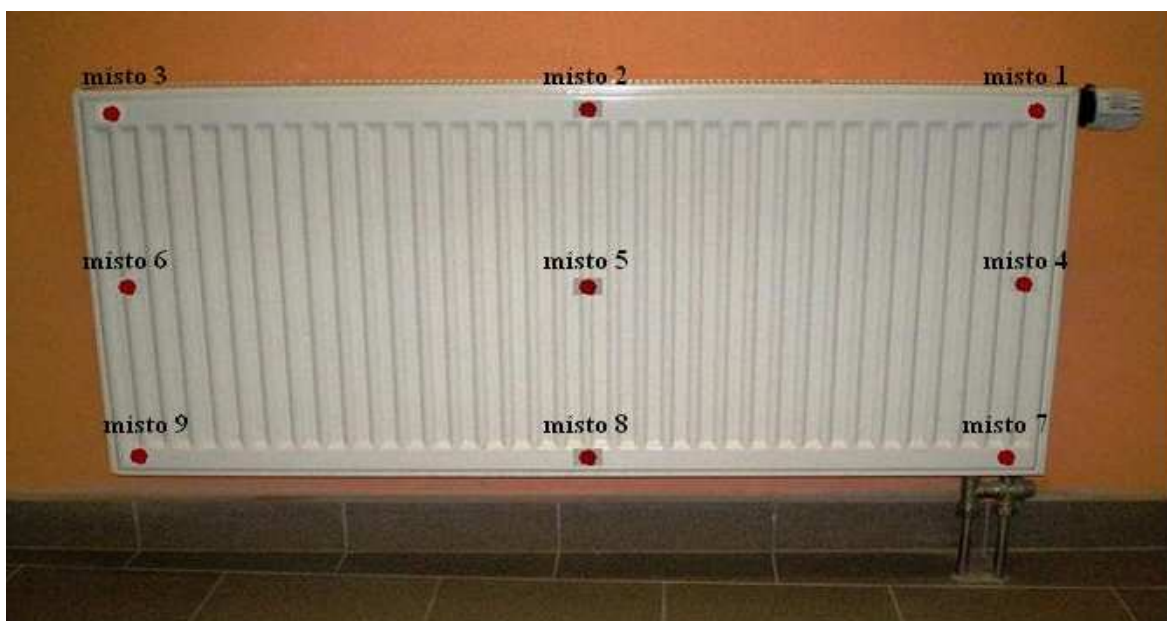
Obr. 15. Rozložení měřících míst na otopném tělese KORADO
