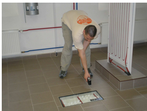
Obr. 28. Měření teploty povrchu OT
