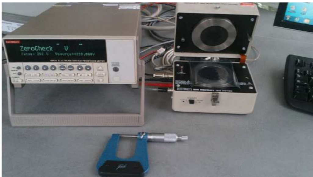
Obr. 27 Soustava pro měření povrchové a objemové rezistivity, nalevo elektrometr Keithley 6517A, napravo elektrodové zařízení Keithley 8009
