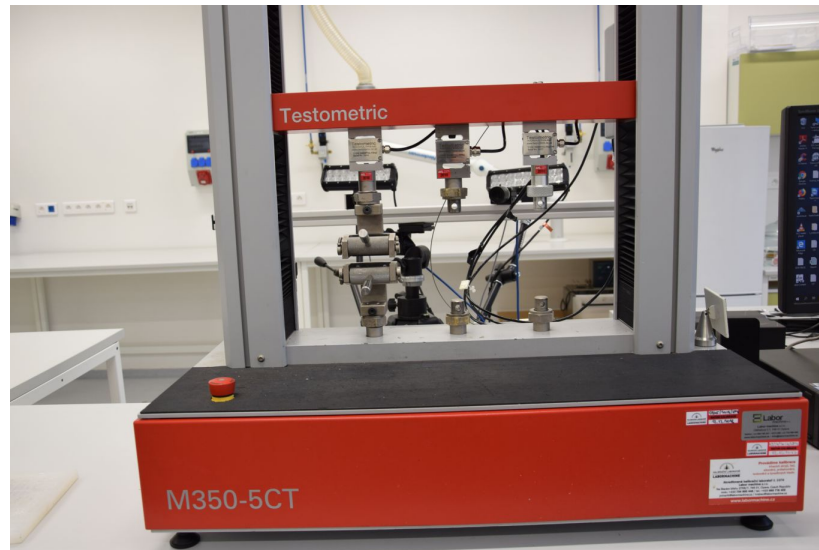
Obr. 25 Tahové zařízení Testometric MT 350-5CT (Testometric)
