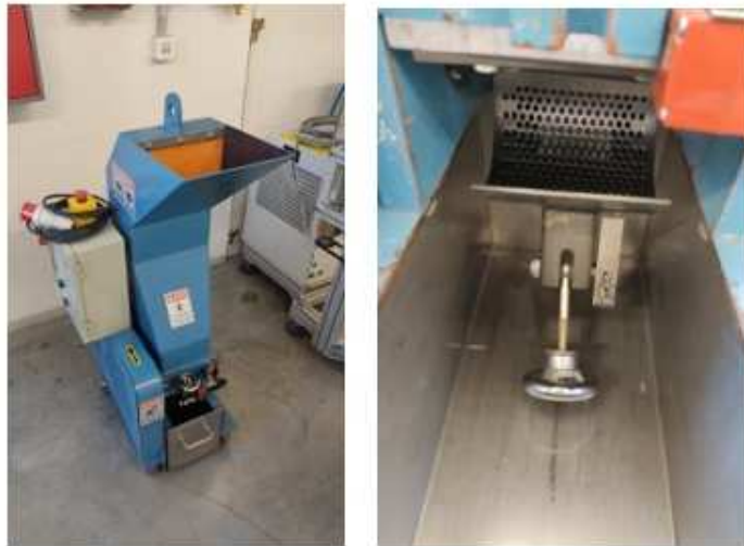
Obr. 32 Nožový mlýn – granulátor (vlevo), pracovní část nožového mlýnu (vpravo)
