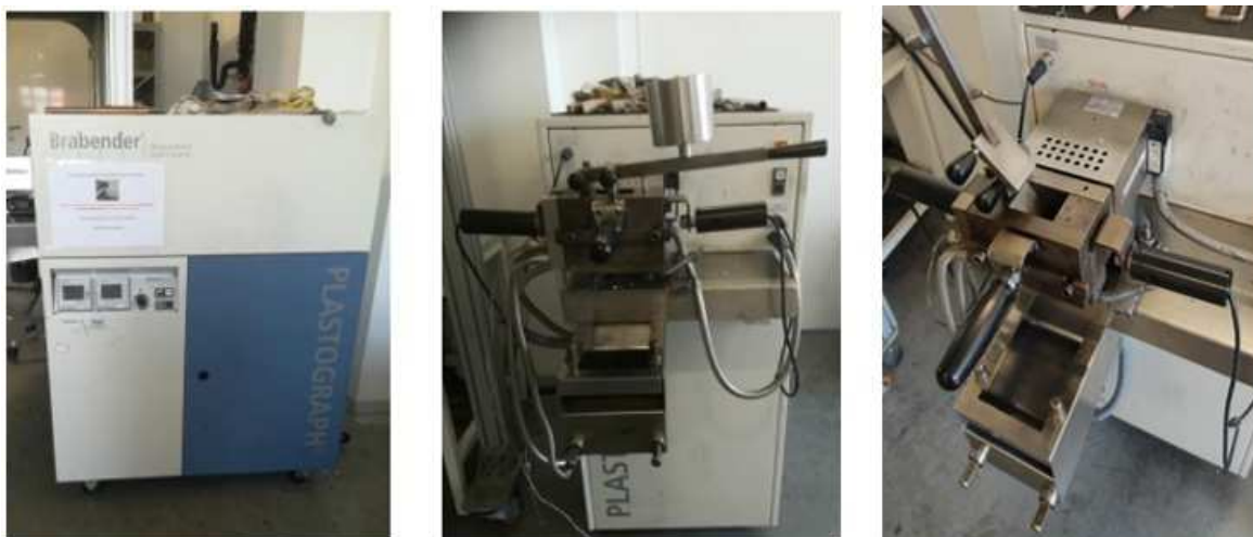
Obr. 31 Hnětič W50 ETH PL (Plastograf)
