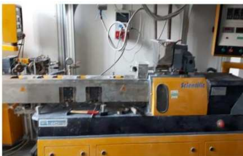
Obr. 48 Dvou-šnekový vytlačovací stroj LabTech Twin Screw Extruder (Scientific)
