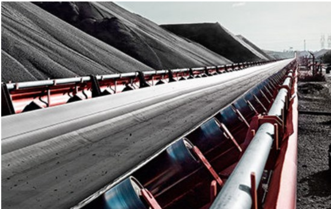
Obrázek 6 Séglová tkanina použitá na dopravníkovém pásu (Interní dokumentace podniku)
