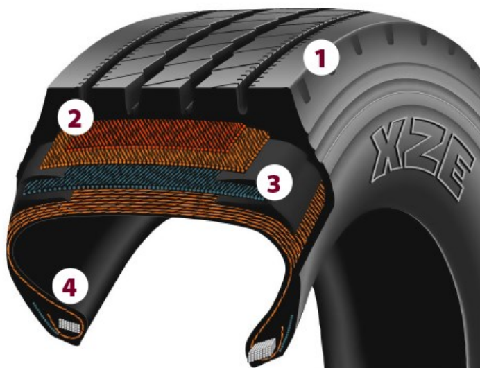
Obrázek 5 Složení pneumatiky s viditelným umístěním kordu v pneumatice (Interní dokumentace podniku)
