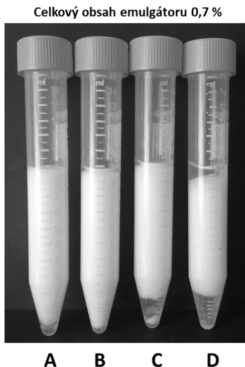
Obrázek 27 Vzhled emulzí po dvou týdnech od přípravy, A: cCNC:TiO 2 4:1, O/V 20/80, B: cCNC:TiO 2 4:1, O/V 30/70, C: cCNC:TiO 2 3:2, O/V 20/80, D: cCNC:TiO 2 3:2, O/V 30/70
