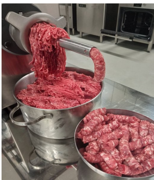
Obrázek 5 Mlýn na maso vytlačující masnou složku kolem trubky s kolagenní tkání
