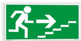
Únikové schodiště vpravo nahoru
