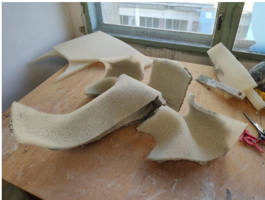
Obr. 51 – Forma na tvarování ze sádry a polyuretanové pěny
