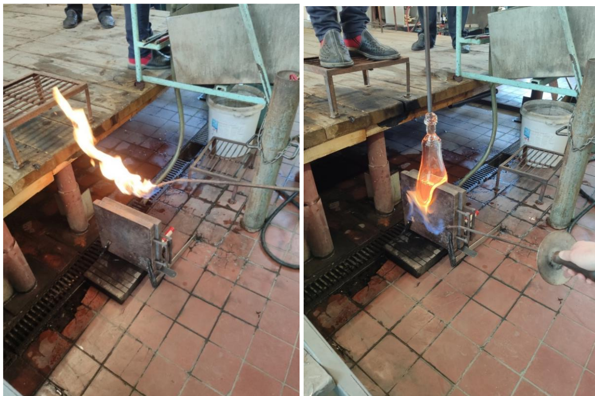
Obr. 57 – Zahřátí kovového kopyta hořákem a foukání přes něho.
