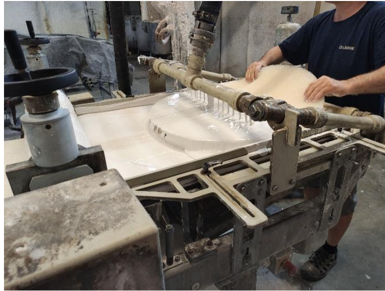
Obr. 39 – Namočení do keramické suspenze
