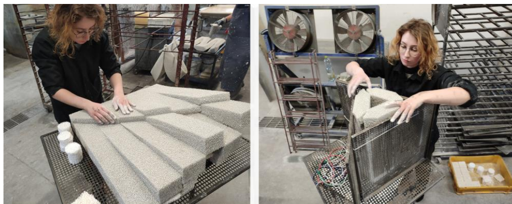
Obr. 42 – Tvarování objektů pomocí kovové konstrukce
