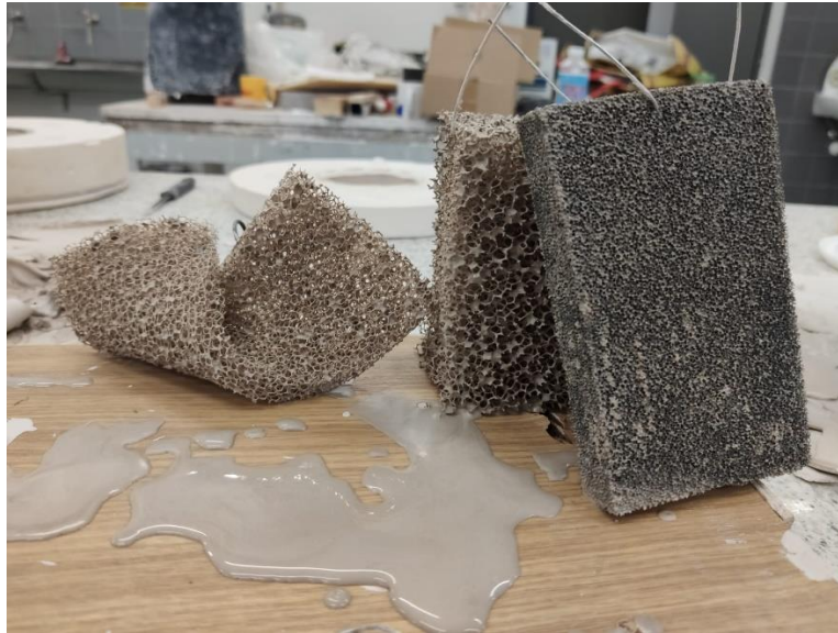
Obr. 37 – Polyuretanová pěna před vypálením porcelánu
