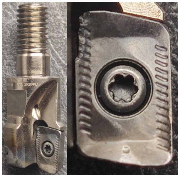
Obr. 85 – Opotřebení břitové destičky XOMX10T308TR-ME07 MS2050 s tělesem R217.69-0816.RE-10-2A
