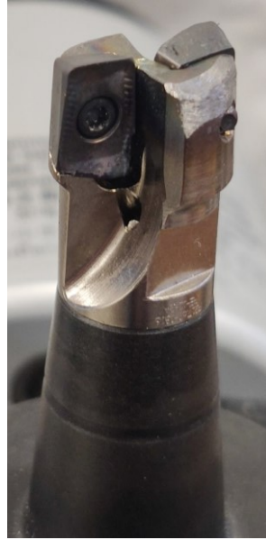
Obr. 84 – Nástroj R217.69-0816.RE-10-2A po obroušení zapečených třísek
