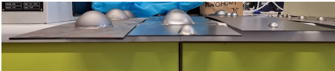
Obr. 52 – Tloušťka plechů z oceli 1.4376 (zleva tloušťka 3 mm, 1,5 mm a 1 mm)
