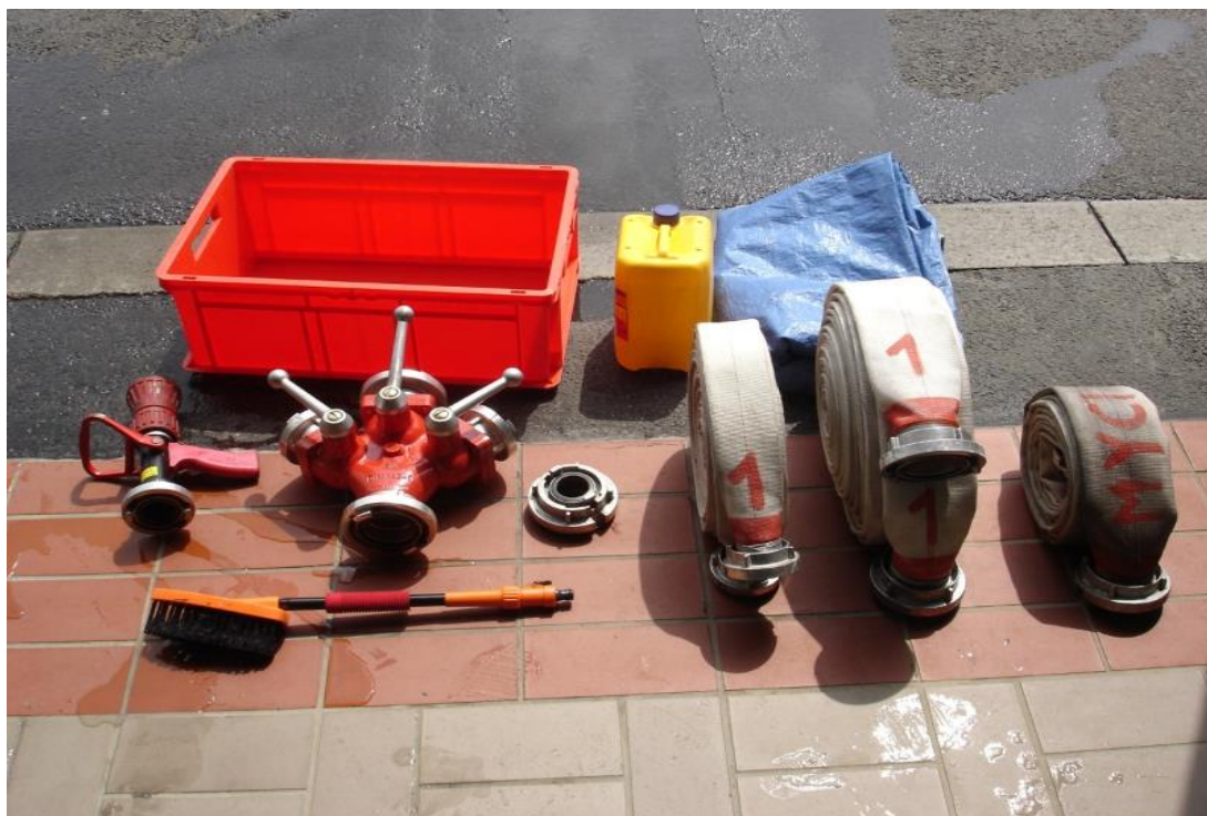
Obrázek 4: Technické prostředky pro zjednodušenou dekontaminaci (Zdroj: Blažek, 2014) Jednou z možností je vytvoření pracoviště a záchytné vany zabraňující odtoku odpadní vody pomocí prostředků na Obrázku 4 . Pro vytvoření zdroje tlakové vody se púlspojka hadice
