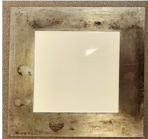
Obrázek 18 Podložka z elastického odlévacího polyuretanu pro tribologickou analýzu (Zdroj: autorka, 2022)
