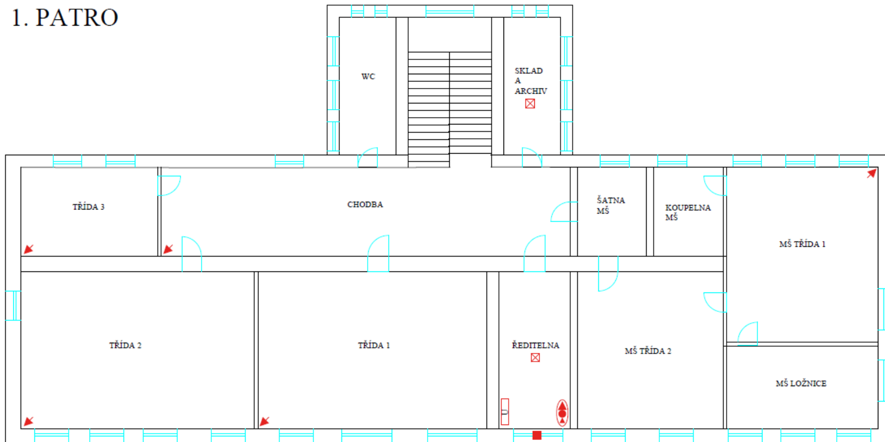
Obrázek 18 Rozmístění prvků PZTS v 1. patře (vlasní)
