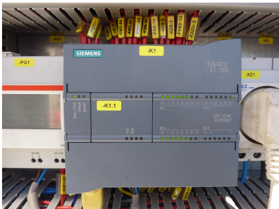
Obrázek 31 - Úspěšné sepnutí všech okruhů na reálném PLC
